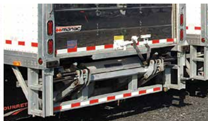
Cadre de porte prêt pour l'installation d'un panneau élévateur
