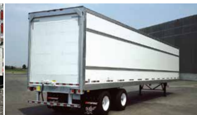
Porte levante sur rails. Bandes de frottement
