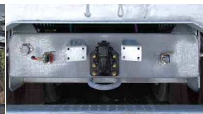
Crochet d'attelage avec sorties électrique et pneumatiques
