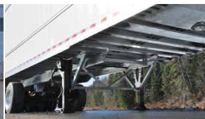
Plaque d'accouplement, traverses, glissières et sous-châssis en acier galvanisé
