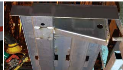
Extension de plancher arrière de 24 po en acier
