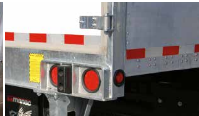
Connexion arrière avec rivets en acier inoxydable (32)
